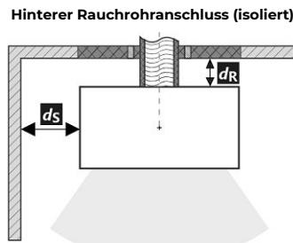
**Durchgang des Rauchrohrs durch eine Wand aus brennbarem Material**
