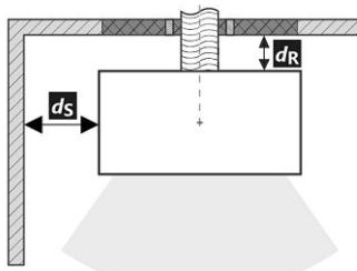
**Passage du conduit de fumée à travers un mur en matériau combustible**
