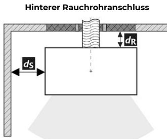
**Durchgang des Rauchrohrs durch eine Wand aus brennbarem Material**
