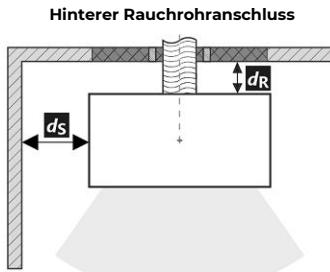
**Durchgang des Rauchrohrs durch eine Wand aus brennbarem Material**
