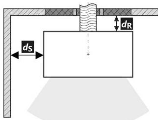
**Passage du conduit de fumée à travers un mur en matériau combustible**
