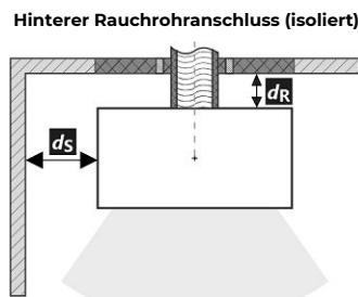
**Durchgang des Rauchrohrs durch eine Wand aus brennbarem Material**
