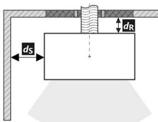
**Passage du conduit de fumée à travers un mur en matériau combustible**
